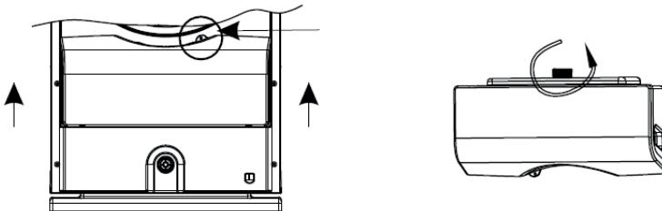
1. Verwijder de schroef met een schroevendraaier en til de watertank aan beide zijden op. Houd hem hierbij recht.
