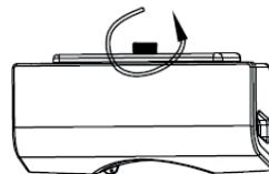
1. Die Schraube mit einem geeigneten Werkzeug lösen. Anschließend den Wassertank beidseitig greifen und gerade nach oben hin herausnehmen.
