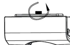
1. Retirer la vis et soulever le réservoir d'eau de la même façon des deux côtés.
