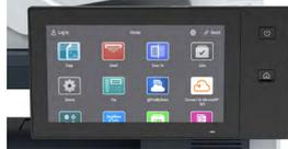
**Ein anpassbarer, Tablet-artiger Touchscreen** ermöglicht Ihnen, noch mehr mit weniger Berührungen und Schritten zu erledigen. Der C625 Multifunktionsdrucker verfügt über eine kippbare 7-Zoll-Bedienungsoberfläche, während der C620 über eine 5-Zoll-Bedienungsoberfläche verfügt. Beide bieten einfachen Zugriff auf die Xerox App Gallery.
