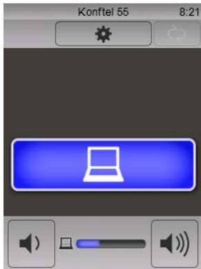
Normalerweise aktiviert der Computer nur den Lautsprecher im Konftel 55 so lange Sie kein Programm starten, das das Mikrofon verwenden kann. Dies bedeutet, dass das Konftel 55 wie ein Computerlautsprecher funktioniert und dass die Tonbearbeitung durch OmniSound® ausgeschaltet ist. Der Sound wird also direkt übertragen.
