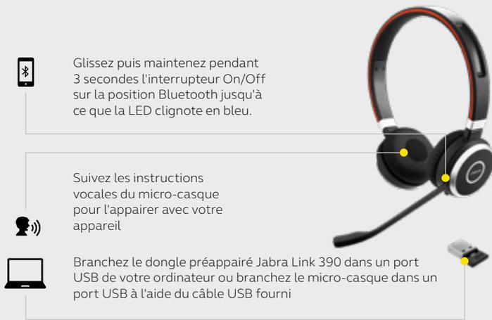
Glissez puis maintenez pendant 3 secondes l'interrupteur On/Off sur la position Bluetooth jusqu'à ce que la LED clignote en bleu.
