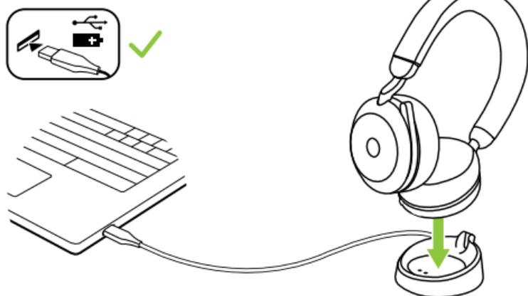
Die Busylight und Status-LED blinkt kurz, um anzuzeigen, dass das Headset korrekt in der Ladestation angedockt ist.
