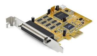
Fügen Sie Ihrem Desktop-Computer über PCIe-Erweiterungskarten-Steckplätze acht serielle RS-232-Ports (DB9)hinzu. Diese serielle PCI-Expresskarte mit Breakoutkabel mit 8 Anschlüssen bietet mehrere Anschlüsse, um eine Vielzahl von seriellen Peripheriegeräten mit Geschwindigkeiten von bis zu 921,4 Kbit/s anzuschließen.
